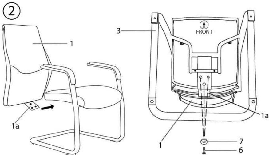
**2.** Прикрутите спинку (1) к каркасу (3) через отверстия в бег-баре спинки (1а), используя три винта (6) и шайбы (7). Кресло готово к эксплуатации.
