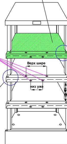
**Внимание:** Корпуса и крышки порога разделителя, устанавливать как показано на рисунке. Т.е чтобы пуклевки на крышке между которыми расстояние больше находились наверху, а между которыми меньше - внизу
